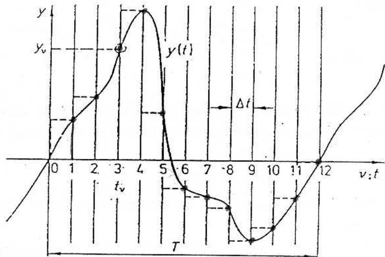
Die Funktion  $y(t)$  wird dazu in  $2 \cdot m$  Zeitabschnitte  $\Delta t$  unterteilt. (Siehe Diagramm)
