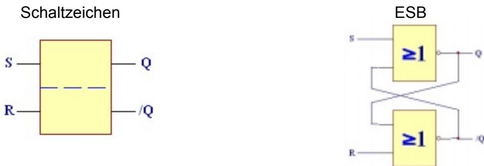
Die meisten RS-FF haben einen Setz- (S) und einen Rücksetzeingang (R). Oft wird neben dem Ausgang Q auch der negierte Ausgang /Q herausgeführt. Das RS-FF entsteht durch einfaches Verschalten zweier NOR-Glieder. (siehe ESB)
